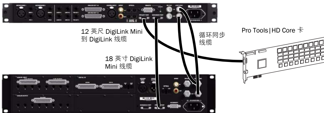
图 5. 与 HD OMNI 和 HD I/O 建立 Digilink 和循环同步连接
