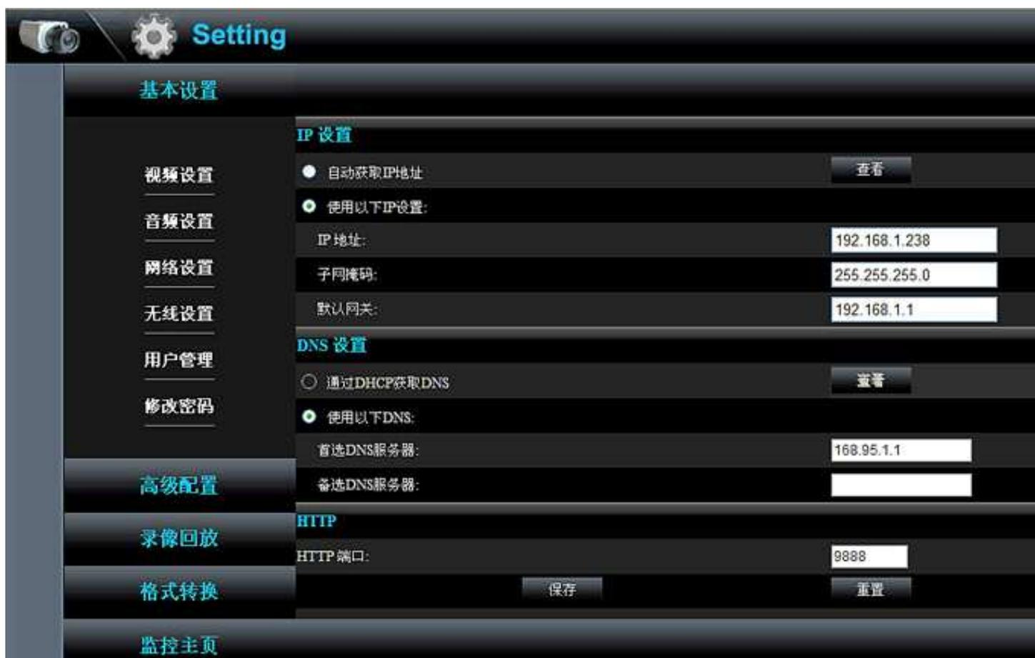
网络设置主要分为 IP 地址设置和 DNS 设置两部分。基于局域网的设置，包括设置 IP 地址，子网掩码，网关。IP 地址出厂默认值为 192.168.1.238，子网掩码出厂默认值为 255.255.255.0，网关出厂默认值为 192.168.1.1，http 端口出厂默认值为 9888。这些参数设置简单，设置完毕后单击【保存】按钮后即完成设置。
