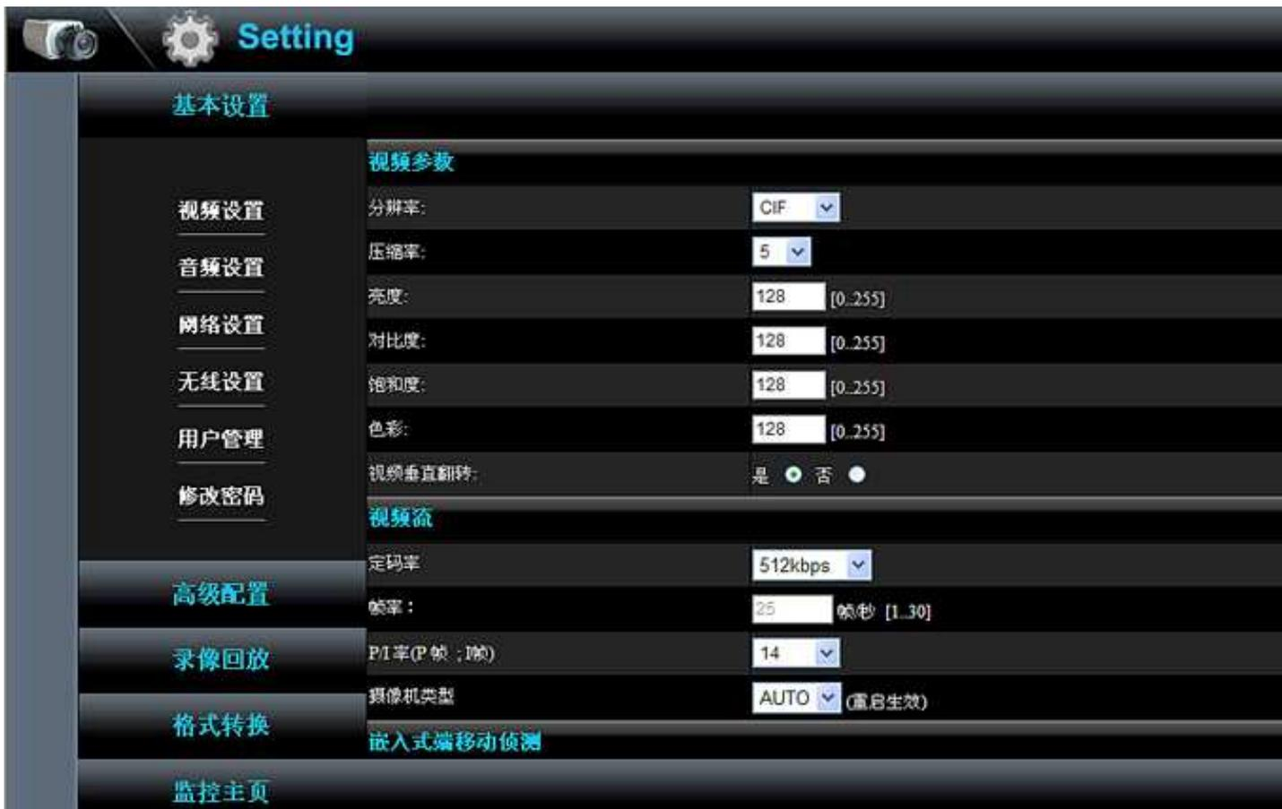
要对视频参数进行设置，以获得最佳的图像质量。视频参数包括：分辨率、压缩率、亮度、对比度、饱和度、色彩。视频参数的设置菜单如上图所示。
