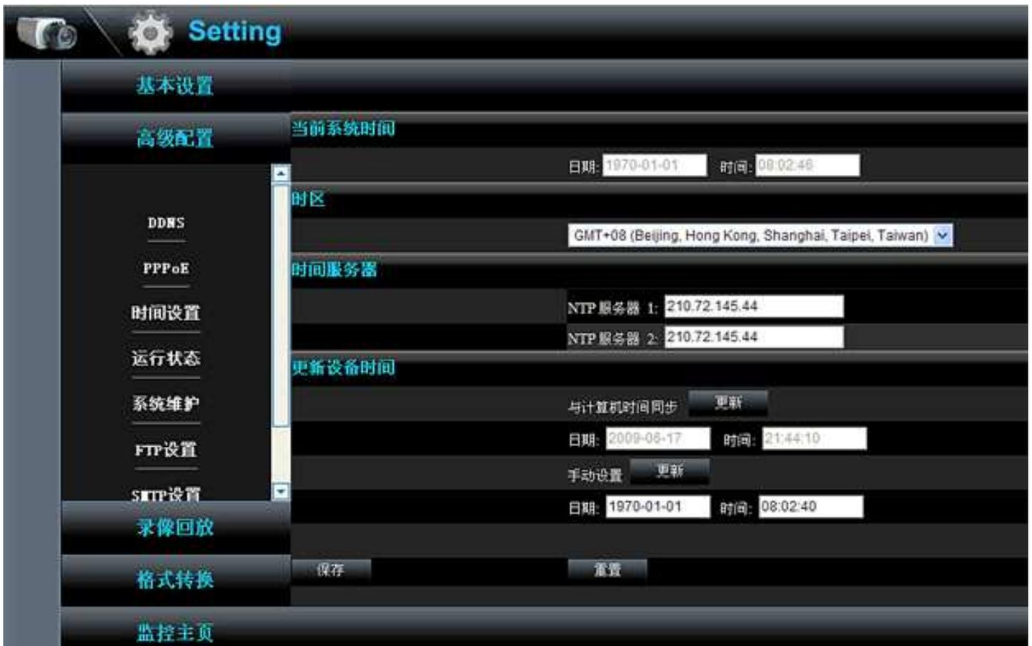
**时间服务器 (NTP Server):** 该项用来设置 NTP Server 的 IP 地址(最多可以输入两个)。NTP Server 是网络时间服务器,用于互联网上的计算机时间同步。该网络摄像机中内置了一些常用的 NTP Server 地址,一旦与 Internet 连接后,网络摄像机可以自动获取系统时间。但是,若此处设置了该项,则当路由器获取 GMT 时间时,将优先从已设置的时间服务器上获取。
