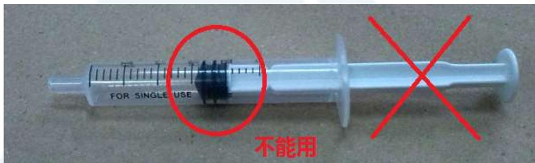
4.2.1 固晶胶拿出冰箱后，需在常温下回温 1 小时，期间不可打开固晶胶瓶盖。先用针筒活塞沾上少许固晶胶用于润滑，然后如下照片的方法抽取固晶胶。
