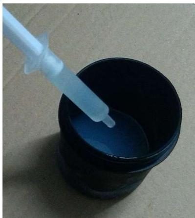
4.1.3 抽取固晶胶后，清洁针筒头，然后装上堵头密封。
