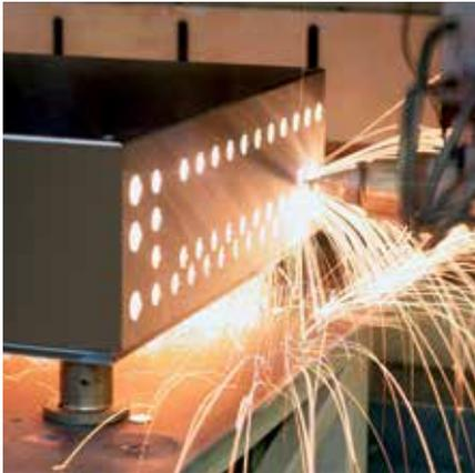
Convergent Photonics的CX3000二氧化碳激光器用于不锈钢燃烧室切割。
