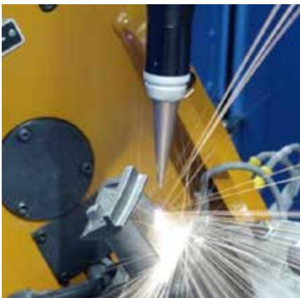
Convergent Photonics的CL50K Nd:YAG激光器用于航空涡轮叶片的钻孔。
