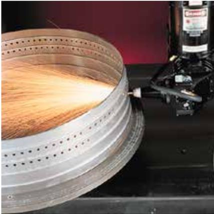
Convergent Photonics的CL50K Nd:YAG激光器用于精密加工飞机发动机部件。
