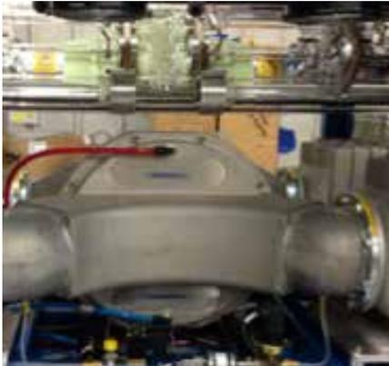
CP4000二氧化碳激光器改进配有新的磁悬浮轴承涡轮机得以提高性能和更低的维护成本。
