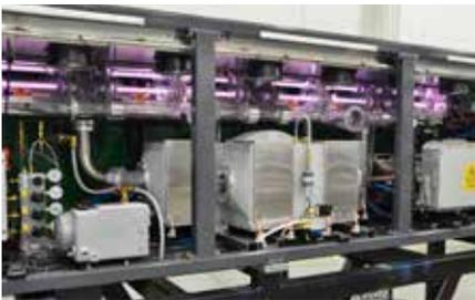
CM系列激光器涡轮机运用磁性轴承得以节约维护成本。
