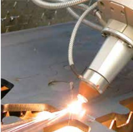
Convergent Photonics的CV5000二氧化碳激光器用于12mm低碳钢三维斜面切割。
