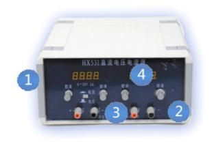
第一步:整机连接 220V 交流电源后,打开机箱左侧电源开关。
