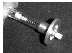
大炉体(LF)的 气体出口管道
