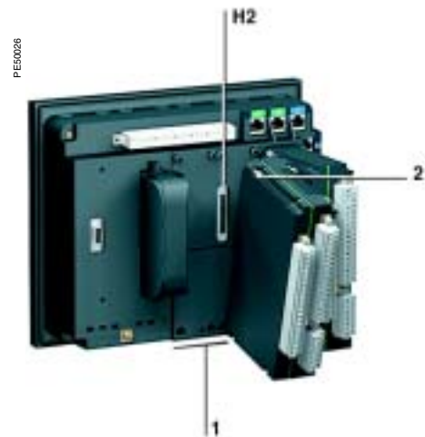
第 2 个 MES120 模块的安装，连接至基本单元接头 H2。
