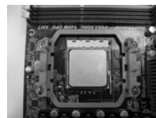
步驟 4： 下推並鎖住插座拉桿
