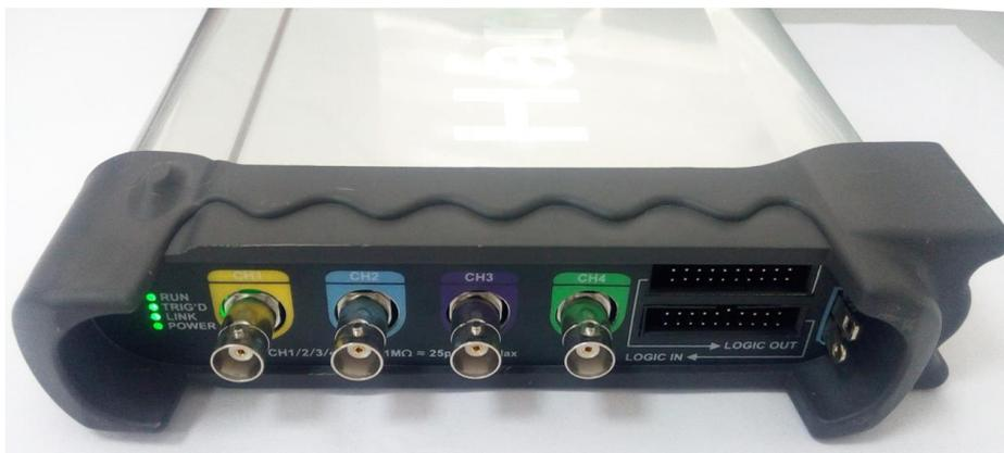
**CH1/CH2/CH3/CH4:** 波形数据端口
