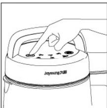
请将机头按正确的位置放入杯体中，插上电源线，指示灯全亮，按“选择”键，选择相应功能程序，当选择的功能对应图形指示灯亮时，按“启动/取消”键，启动相应的制作程序。
