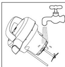
1. 机头：请用水轻轻洗去机头下部粘附的豆浆或其它东西，切勿将机头浸入水中，也不要用水清洗机头上部，以防止机头进水，发生短路现象。
