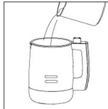
请加水至上、下水位刻度线之间。（本机具有无水防干烧功能，如杯体内无水或水位过低，机器不会工作，以保证使用安全。）
