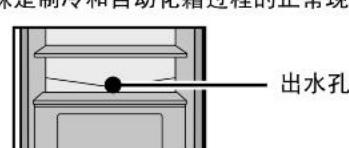
警示 一定要保持保湿盒上方的出水孔畅通，使化霜水通畅地经此处流出，若出水孔堵塞，请使用随机附件中的透孔销进行疏通。
