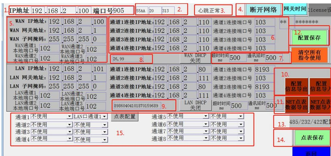
1. 为要连接的网关的 IP 地址和端口号，出厂时,网关的连接 WAN 口默认 IP 为 192.168.2.100，端口号为 905
