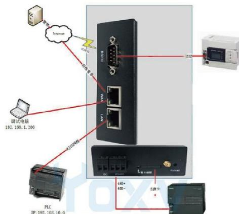
网关与多台设备使用网线连接时，可以通过交换机实现多台设备组网连接通讯；
