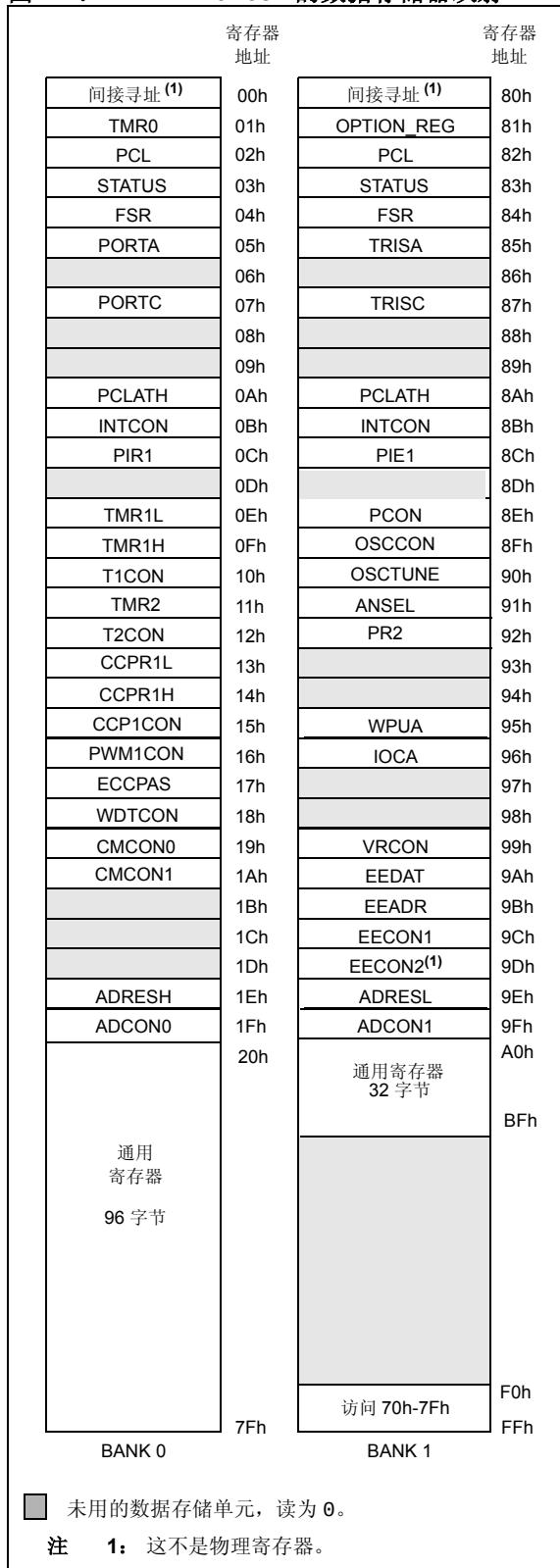
图 2-2: PIC16F684 的数据存储器映射
