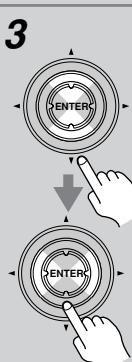
使用上下 [▲]/[▼] 键选择输入源，然后使用左右 [◀]/[▶] 键选择：Coax 1, Coax 2, Opt 1, Opt 2, Opt 3, Opt 4, No（模拟）。如希望使用带模拟输入的输入选择器，请选择 No。
