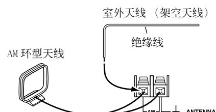
AM 室外天线水平安装在户外，接收的效果最好。但是有时水平安装在室内窗户的上方也能收到好的效果。注意 AM 环型天线要保持连接。
