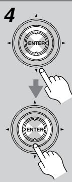
使用上下 [ $\blacktriangle$ ]/[ $\nabla$ ] 键选择一种信号格式，然后使用左右 [ $\blacktriangleleft$ ]/[ $\triangleright$ ] 键选择一聆听模式。
