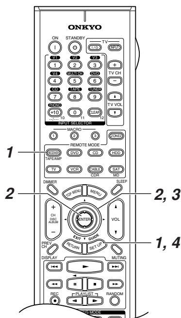
如果连接视频设备到 HDMI IN 1 或 2 接口，您必须将该接口分配给某个输入选择器。例如，如果您将 DVD 播放机连接到 HDMI IN 1，您就必须将 HDMI IN 1 分配给 DVD 输入选择器。
