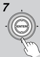
**7** 使用上下键 [ $\blacktriangle$ ]/[ $\triangledown$ ] 选择「d. Surround」然后使用左右键 [ $\blacktriangleleft$ ]/[ $\triangleright$ ] 选择交叉频率。如果没有连接左右环绕扬声器，选择 None。
