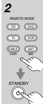
一边按住希望输入编码的 REMOTE MODE 键，一边按下 [STANDBY] 键。
