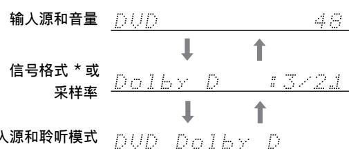
\* 如果输入信号是模拟信号，屏幕上不会显示任何格式信息。如果输入信号是 PCM，屏幕上会显示采样率。如果输入信号是数字而非 PCM，屏幕上会显示信号的格式。
