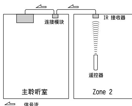
按下图所示，将连接模块的多插头连线与 AV 接收机的 IR IN 接口相连接。
