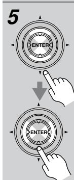
使用上下 [ $\blacktriangle$ ]/[ $\nabla$ ] 键选择各扬声器，然后使用左右 [ $\blacktriangle$ ]/[ $\triangleright$ ] 键设定距离。
