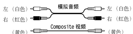
· 向一个方向推插头, 确保连接正确(连接松动会产生噪音或功能失常)。
