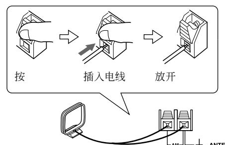
释放如果准备使用 AV 接收机，需要调谐 AM 电台，并调整天线位置达到最佳聆听效果。将其尽量置于远离 AV 接收机机，电视，扬声器连接线以及电源线的地方。
