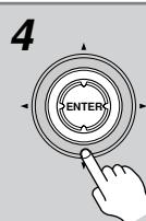
使用上下 [ $\blacktriangle$ ]/[ $\nabla$ ] 键选择扬声器，使用左右 [ $\blacktriangleleft$ ]/[ $\triangleright$ ] 键来设置音量。
