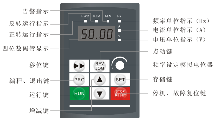
图 4-2 本机操作键盘示意图
