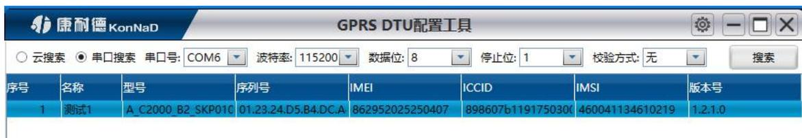
选中搜索到的设备，单击右键弹出设备参数设置的快捷菜单，选中设置选择“**设置**”弹出设备设置主界面，设置的参数主要分**设备信息**、**网络参数**及**详细信息**三部分。下面详细介绍这三部分设置。
