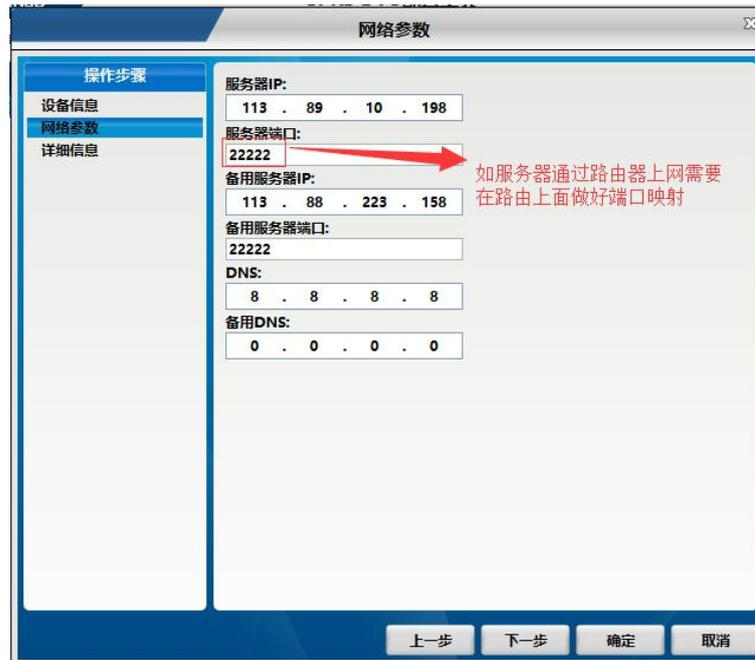
假设服务器通过路由器连接到网络，那么需要在路由上做好端口映射，如下图所示。因为设备里面设置的服务器端口为 22222，所以这里设置的端口也为 22222。不同路由器的端口映射方法可能不同，如有问题可咨询路由器厂家。
