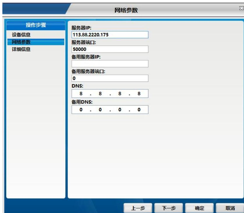
**服务器IP、服务器端口:**GPRS DTU连上GPRS网络后会主动连接这里设置的服务器IP和端口, 注意这里需要填的IP必须为公网IP或者是域名,并且如果服务器是通过路由器连接到网络的话需要在路由器上面做好端口映射。
