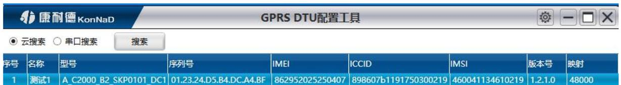
搜索到设备后，设备的设置方法同串口搜索到的方式一样，唯一不同点是通过网络搜索到的设备可以设置一个映射端口。右键选择设备，在弹出的快捷菜单中选择“映射”即可设置映射端口。
