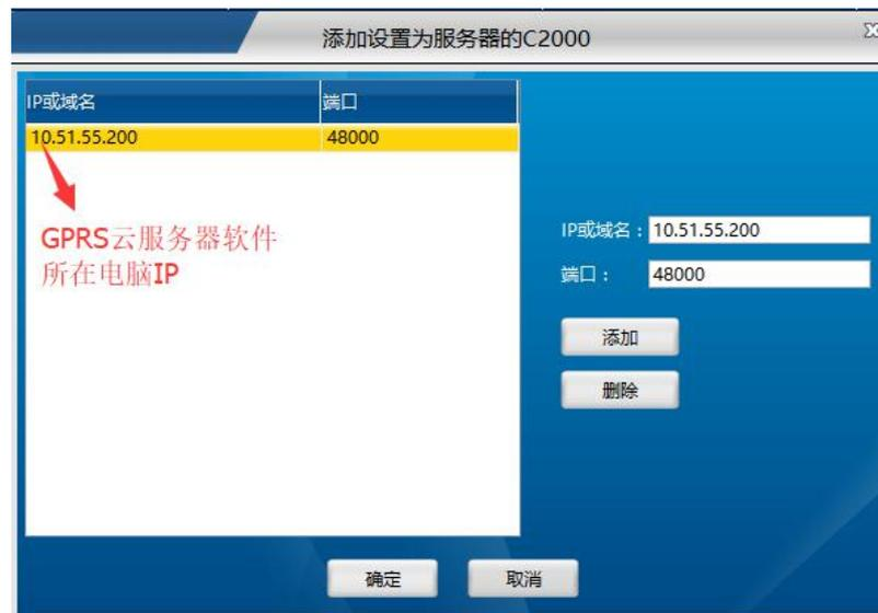
添加完成后可以看到 GPRS DTU 已经自动出现在“连接未创建设备”组里面。选中设备，可以将其拖到默认设备组或其他自建组里，拖到设备时将出现一个
