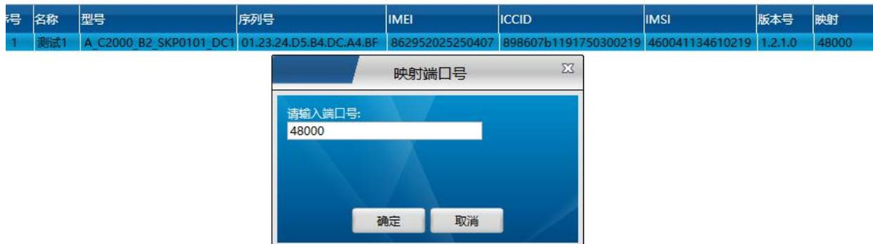
每个 GPRS DTU 可以映射一个端口，应用程序可以通过这个映射的端口和 GPRS DTU 进行通信。
