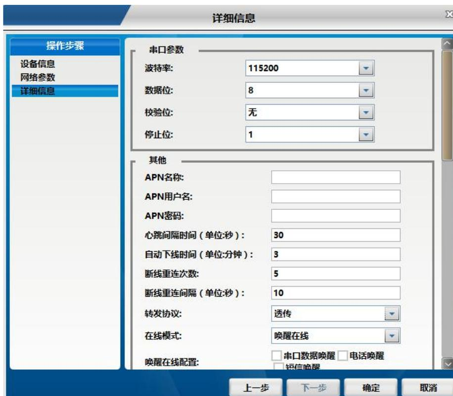
**串口参数:** GPRS DTU 的串口波特率、数据位、校验及停止位的串口参数设置。使用时请根据 GPRS DTU 串口下接设备参数进行设置。
