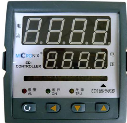
该显示控制器是我公司技术专家根据多年 EDI 膜块使用中客户所遇到的如何早期预测膜块开始被污染而采取预防措施的问题，自行研制出智能型产品。该产品配套 MXD-3 型整流电源，采用模拟运算方法对 EDI 模块进行在线检测，将膜块因受污堵而导致内阻电压升高的数学模式，直观的用显示方法显示出 EDI 模块在运行中受到污染的程度，提前预警客户及时的对 EDI 模块进行清洗或做故障处理。
