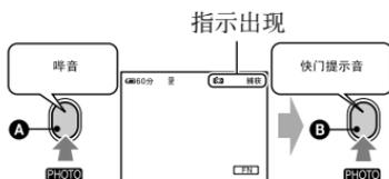
听到快门声音，图像被录制，并带有7秒的声音。
