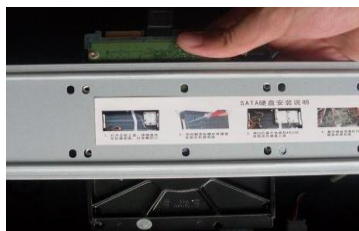
②把硬盘对准硬盘支架的四个孔放置
