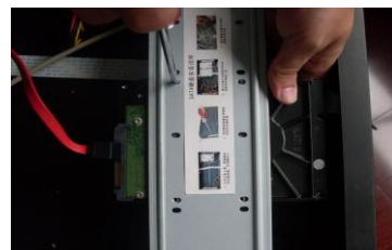
③用四个螺丝将硬盘固定
