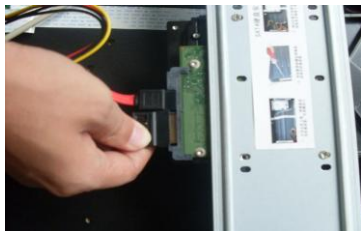
⑥插上硬盘电源线，最后合上机箱盖，予以固定
