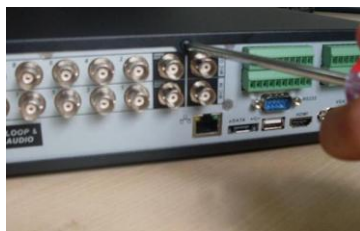
①拆卸主机上盖的固定螺丝
