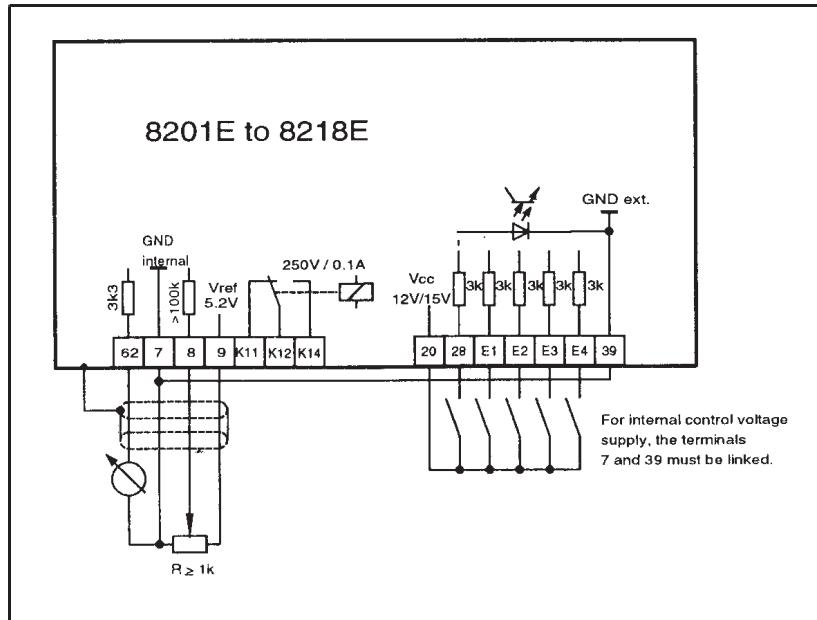
内部电压供电时端子 7 和 39 必须短接
