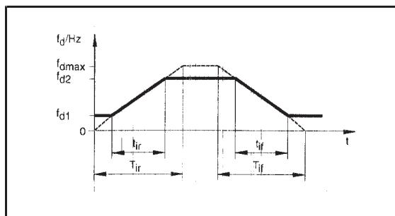
$$T_{ir} = t_{ir} \cdot \frac{f_{dmax}}{f_{d2} - f_{d1}}$$
