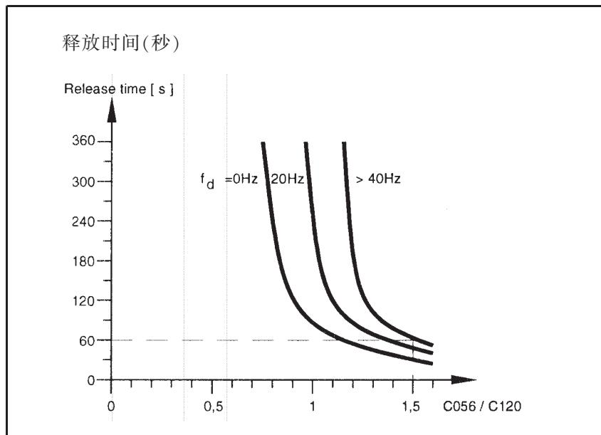
当设置 C120=100%且负载 C056=150%时, 变频器在 60S 后关闭, 如果输出频率小于 40Hz, 则关闭时间还要短一些。
