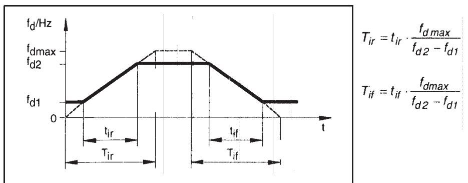
$t_{ir}$  和  $t_{if}$  为  $f_{d1}$  和  $f_{d2}$  间所需的变化时间,  $T_{ir}$  和  $T_{if}$  是由 C012 和 C013 的设定时间
