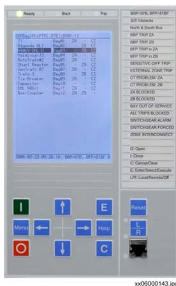
图 5: 中型液晶显示的人机界面，能显示 15 个可控设备
