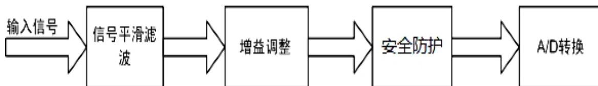
模拟量输入采样前端调理电路图
