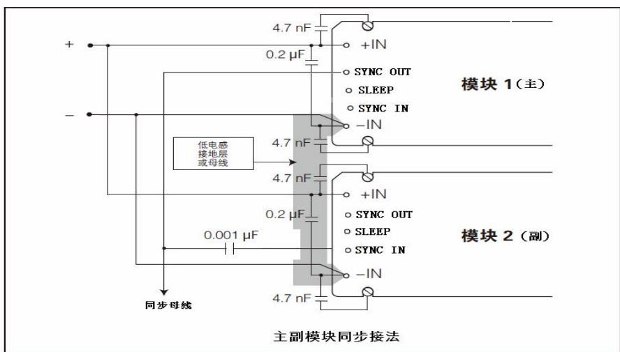
关），外部主时钟信号应有一大于 20ns 的脉宽，这时所有的模块都追随外部的同步频率工作。SYNC IN 同步引脚接接受的电平为 TTL5V 电平，使用时外部同步时钟信号如不是 TTL 电平要加电平转换。同步工作时，由于每个模块都是通过一 0.001UF 的电容交流连接到同步母线上，如果副模块出故障退出了工作，其余的模块不受影响，照常工作。如果是主模块出故障退出了工作，副模块退出同步，各自以本身自有的内定频率独自工作。
