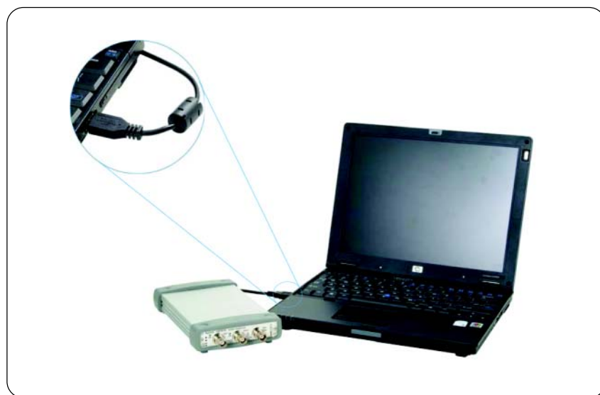
图 4. U2701A 和 U2702A 通过 USB 电缆与台式机或笔记本电脑相连, 以实现快速的数据传输。
