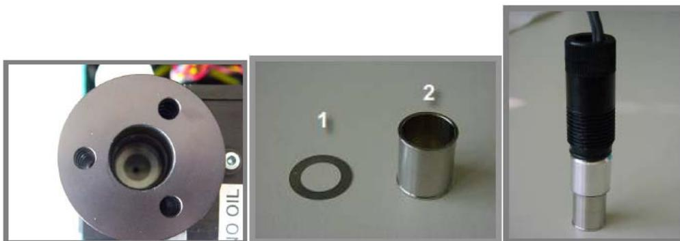
将新红外光源放进去之前，请查看灯罩。用户可以发现在灯罩内有（1）薄垫片和（2）圆柱。请仔细检查该薄垫片的位置。
