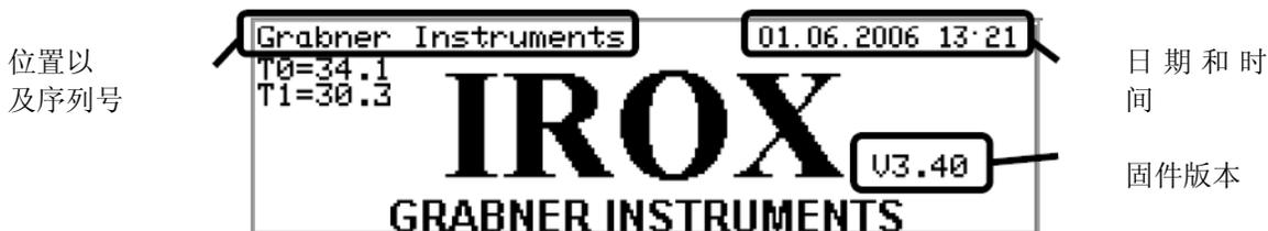
仪器内置的风扇开始运行。大约5秒钟后显示器上的信息变为IROX 2000液压系统的预热循环。T0以及T1会逐渐上升至稳定值，大约为36.0。仪器达到温度平衡大约需要5分钟。
