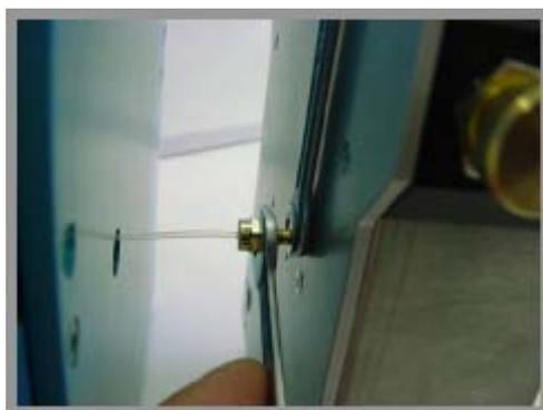
7. 现在固定取样器。取样器上端的两个小孔可通过螺丝使其与安装面板相连。
