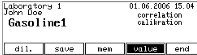
将光标移动至**结束**（**end**），点击**任务**（TASK）按钮就可返回至关联校准菜单。
