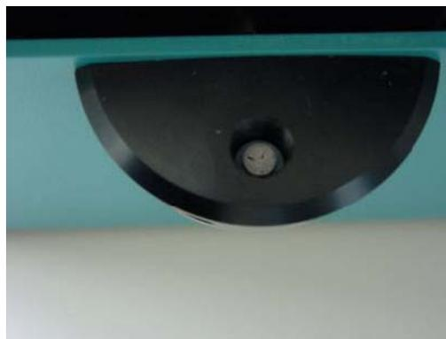
更换过滤器，并拧紧螺旋进口螺丝。过滤器的位置在螺旋进口螺丝的中间小孔中，请小心操作。
