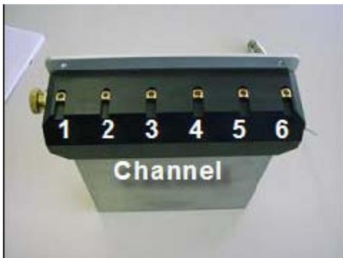
正如用户所见，每个通道对应一个样品；测试时从通道 1 开始样品分析。根据已设置的测试通道，IROX 会持续进行测试，直至最后一个样品，比如说从通道 1 直至通道 4。
