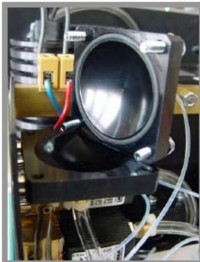
取出两张新滤膜，上下重叠放置，摆放在加料容器的下层壳体里。
