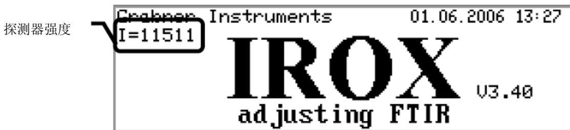
同时探测器自动开始自检。如果自检显示傅立叶转换红外线光谱仪未校直，则开始全自动镜面校直。左上角显示的数字代表强度。干涉仪校直后该数值达到最大值（约为11000）。校直结束后，显示器上显示傅立叶转换红外线光谱仪的校准菜单。
