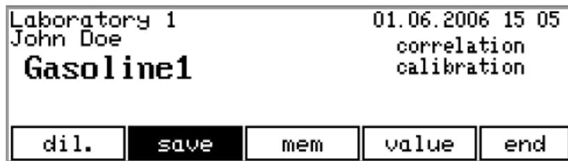
如需退出校准（calibration）菜单，将光标移动至**结束**（**end**），点击**任务**（TASK）按钮。
