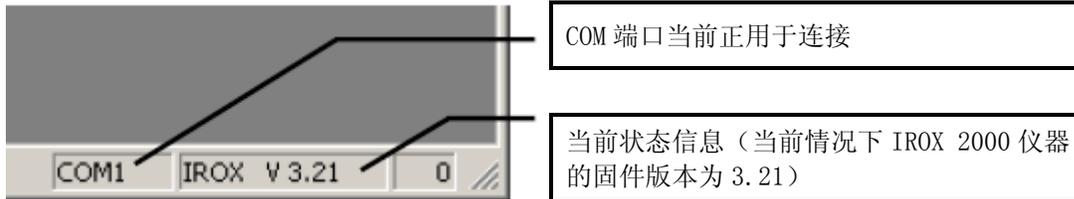
如果此时 IROX 仪器没有任何连接，则 MINIWIN-IROX 软件中显示的 IROX 仪器的连接状态应如下图所示所示：
