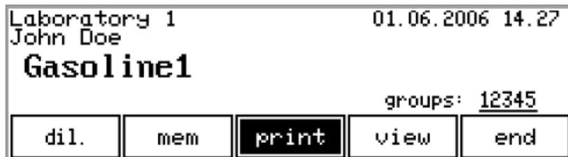
如果打印机一直与IROX 2000相连，仪器会自动打印最后的测试结果，而不需要再将光标移动至**打印**（**print**），点击**任务**（TASK）按钮。
