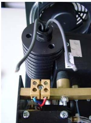
拧开环形螺母，用手托住光谱仪顶部冷却块内的红外光源。小心！当该单元在使用时，该冷却块是烫的。
