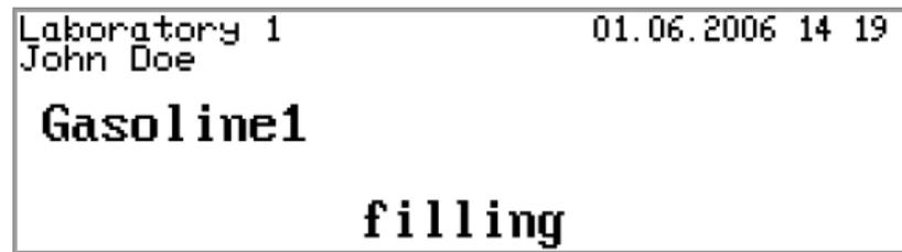
**注意！** 显示器显示“从样品容器中移除软管”的信息前，用户不能从样品容器中移除软管。
