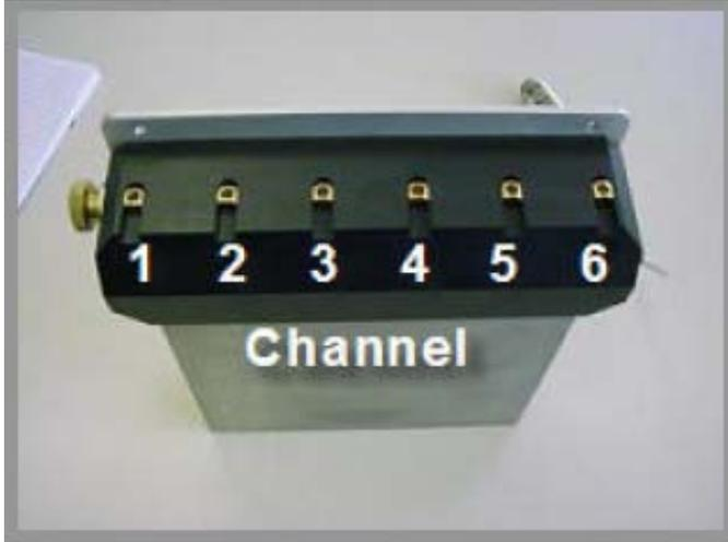
用户可以对多重取样器 6 个可用进口的样品名称进行编程设计（上图显示的数字）。
