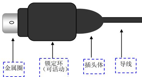
图 2-13 铃流馈电电源插头结构
