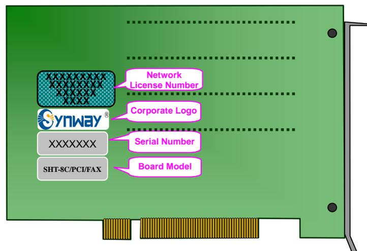
图 2-2 主板示意图(后视图)
