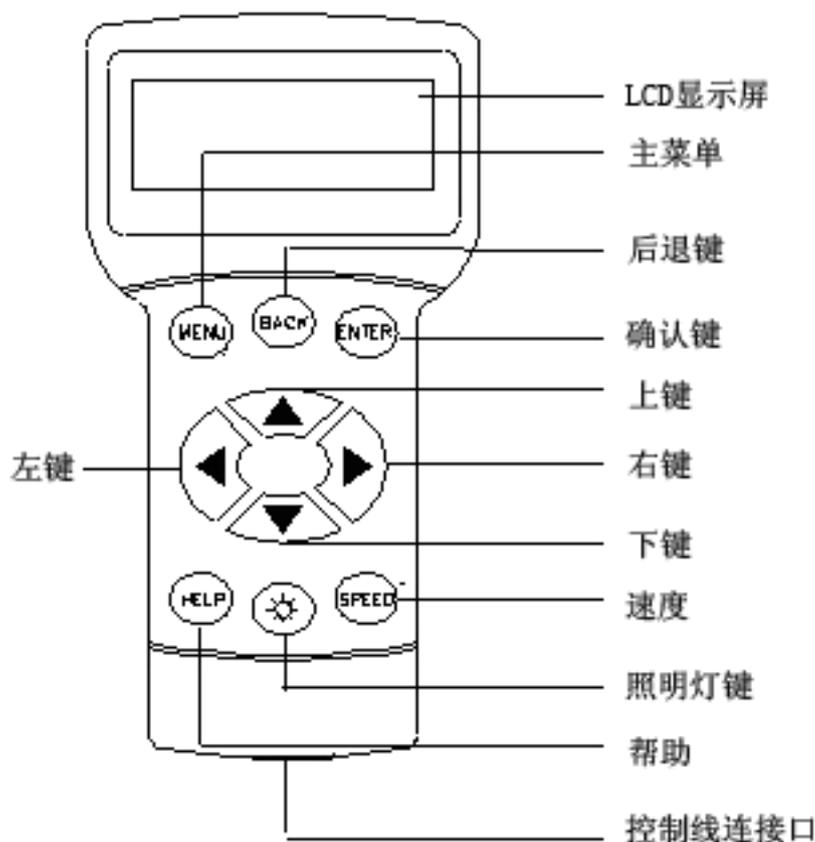
LCD 显示屏：4 行字符显示，2 行汉字显示
