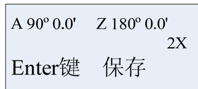
A 和 Z 指示目标位置的高度和方位角。如果转动后发现目标位置有偏差，此时您可以通过按“SPEED”来选择回转速率，然后通过方向键将目标位置调整到望远镜的视场中心，然后按“ENTER”确认。如果转动后发现目标位置无偏差，只可以按“BACK”键返回地面目标显示界面，重新选择你所需要的地面目标来进行观测。操作简单，使用方便，便于您多次反复观测，而避免你重复进入菜单选择的过程。
