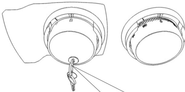
将开关转盘上的锁闭标记转到开关指示刻度线位置，然后将转盘锁的钥匙插入锁孔内，顺时针旋转 180 度，锁闭转盘锁。
