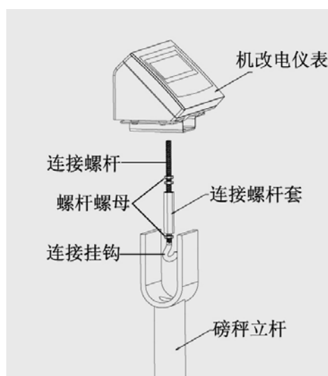
图五: IND-J 机改电仪表的连接 附, IND-J 显示器连接说明
