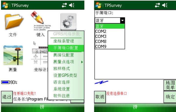
点“配置”选“手簿端口配置”→选“手簿端口”（COM2~3 除外）
