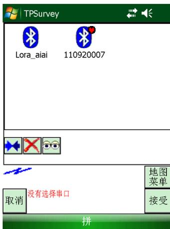
设置“绑定”后主机右上角出现红色圆点，然后点接受即可连接主机
