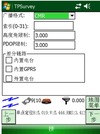
下一步→设置 GPS 差分格式、设站索引、高度角限制、PDOP 限制、差分链路方式。
