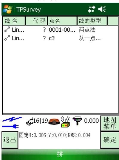
常用于电杆排放、道路放样等。根据界面的导航信息可以快速到达待定直线，方便快捷。线放样有直线放样和直线库放样
