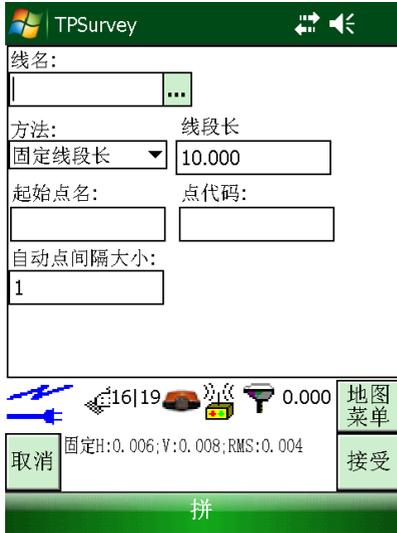
划分的方法有固定线段长和固定线段数两种。划分线的结果可在点管理器中查询，划分点的点代码默认为线段名。
