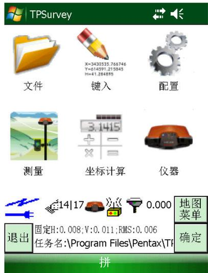
确认流动站工作状态 → 确认后，获得固定解
