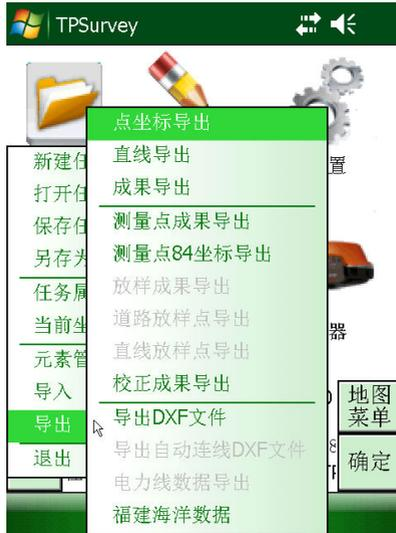
包括点坐标导出、成果导出、测量点成果导出、放样成果导出、校正成果导出、导出 DXF 文件、电力线数据导出、福建海洋数据导出八个选项，下面逐一介绍它们的功能。
