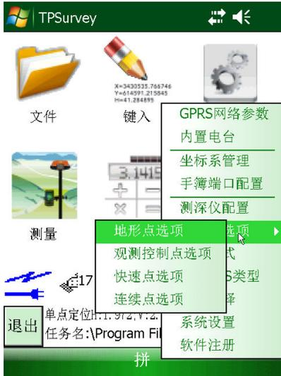
通过设置保存测量的方式，观测时间观测精度等。测量点选项有四个选项：
