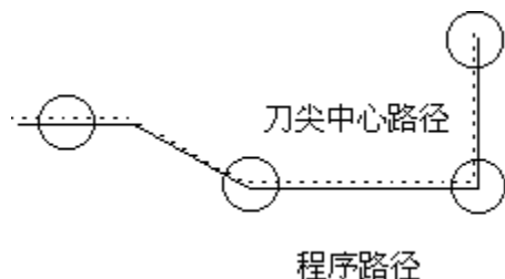
图 1-3 以刀尖中心编程时的刀具轨迹
