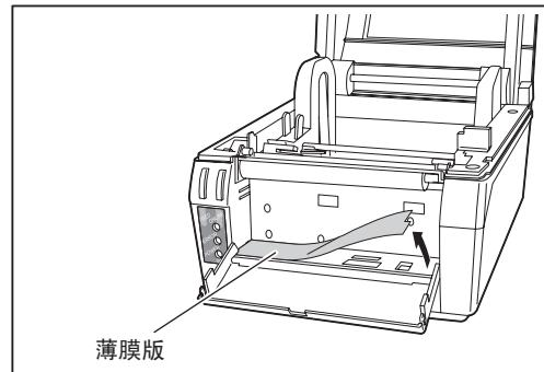
**8** 用手慢慢折下薄膜版上的针孔虚线处，所形成的缺口是为了配合选配件装置连接器的使用。
