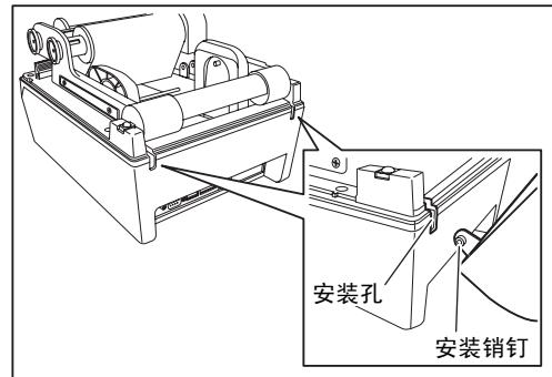
**6** 将打印头锁定拉杆拉到跟前，扶起支架装置。
