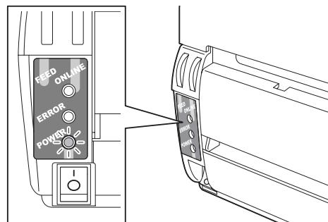
当打印机不处于脱机状态时，可按照下列步骤操作使打印机转换为脱机状态。
