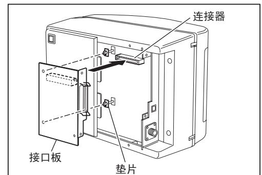
**6** 使用与接口板配套的螺丝将接口板固定在后嵌板上（两处）。
