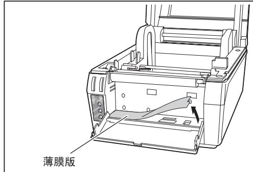
**6** 用手慢慢折下薄膜版上的针孔虚线处，所形成的缺口是为了配合选配件装置连接器的使用。
