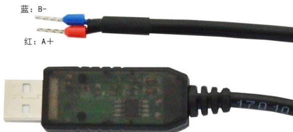
图 1: RS485 转 USB 连接线
