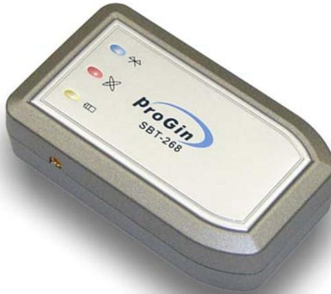
机体正面左侧三个发光二极管分别标示 GPS, 蓝牙和电池的状态。下一章节将对此详细阐述。电池开关按钮在机体的侧面, MMCX 连接口在机体的另一侧。用于电池充电和数据传输的迷你 USB 接口在电池开关的旁边。
