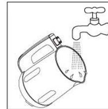
2. 杯体：请用清洁块仔细清洗杯体，将杯体底部以及侧面清洗干净，以免残留的豆浆产生异味。清洗时请勿将杯体浸入水中，请勿用水冲洗耦合器及底座，以防杯体或底座进水引起短路等安全问题。
