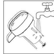
1. 机头：请用水轻轻洗去机头下部粘附的豆浆或其它粘附物，切勿将机头浸入水中，也不要用水清洗机头上部，以防止机头进水，发生短路现象。
