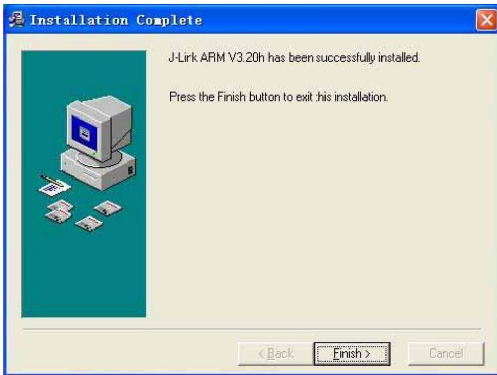
安装完成后，请插入 JLINK 硬件，然后系统提示发现新硬件，一般情况下会自动安装驱动，如果没有自动安装，请选择手动指定驱动程序位置（安装目录），然后将驱动程序位置指向到 JLINK 驱动软件的安装目录下的 Driver 文件夹，驱动程序就在该文件夹下。
