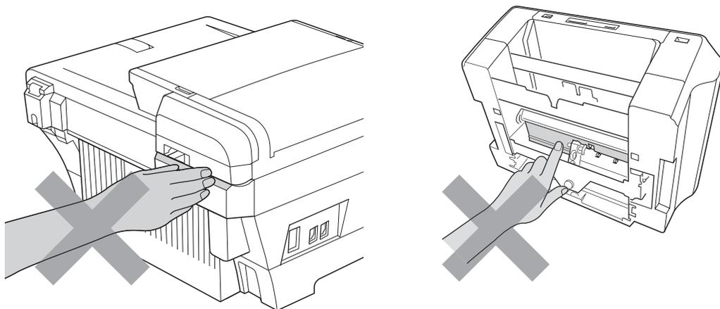
搬动设备时，如图所示，双手分别握住设备两边，将其从底座抬起。请勿握住扫描器盖板或外部后盖来移动设备。
