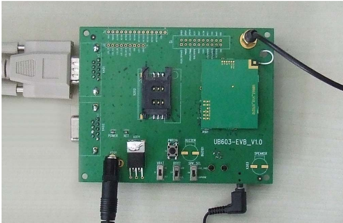
图 3: UB603-EVB 及配件组装图
