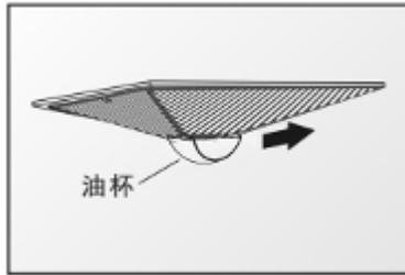
□油杯内储油三分之二时，应及时清理，防止溢出。按图所示，拆下油杯即可。
