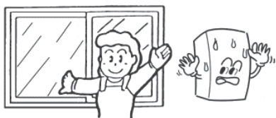
室内不得安装室外型热水器
