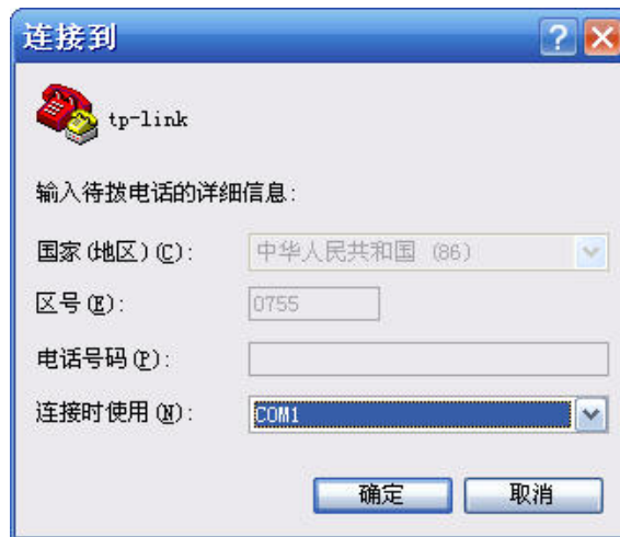
图 1-3 连接端口选择
