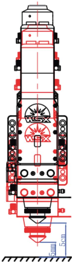
第一步：在距离板面5cm高度点射，激光功率约500W，在板面烧出圆形烧灼面。
