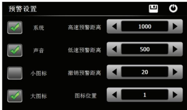
点击系统按钮，取消为不支持电子狗预警，选择为支持电子狗预警，包括移动电子狗预警（需要另外增加移动电子狗）、固定数据电子眼预警。选择完成后点击保存图标，可以保存设置内容，同时会出现相关的图示信息，如下图，您可以选择同意或是不同意按钮。
