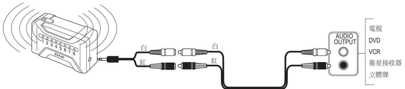
**1** 將提供的RCA至迷你3.5mm音頻電纜連接到RCA音頻電纜(隨遊戲椅配送), 紅對紅, 白對白。連接RCA音頻電纜的另一端至音頻/視頻裝置的音頻輸出插孔, 紅對紅, 白對白。將RCA至迷你3.5mm音頻電纜連接到無線發射器上。
