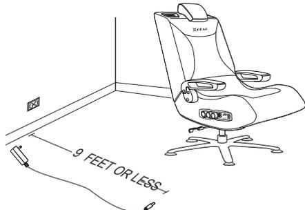
1. 將遊戲椅放置於適當位置，使控制面板距離電源不超過9英尺/2.8米。
