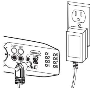
2. 將電源供應器連接到控制面板的直流電源輸入口，然後將電源插到插座上。
