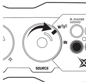
**5.** 旋轉控制面板上的音源旋鈕至 W 檔。
