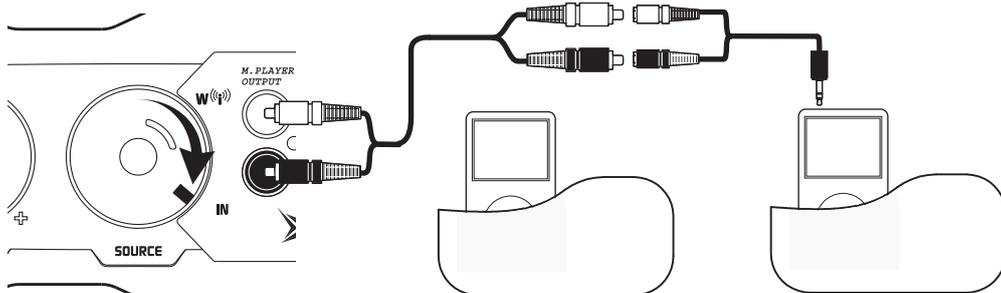
**1** 旋轉控制面板上的音源旋鈕到IN位置。
