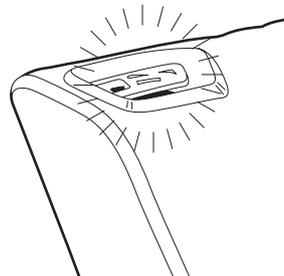
4. 檢查喇叭蓋上的LED是否亮起，旋轉音量旋鈕關機，再連接音頻到您的音頻設備。
