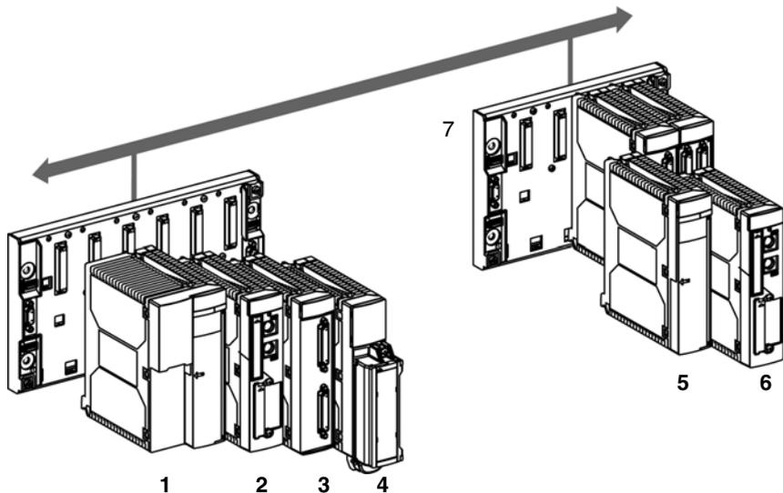
提示：如果第二个机架未配备有处理器模块，则此机架就是一个分布在两个机架上的单独 PLC。
