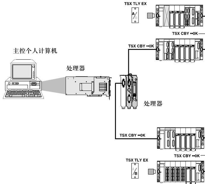
提示：在这种情况下，由于处理器无法在线路开始处进行集成，因此，必须将终结器 **TSX TLY EX A/** 和 **/B** 安装在位于线路终端的每个机架上。
