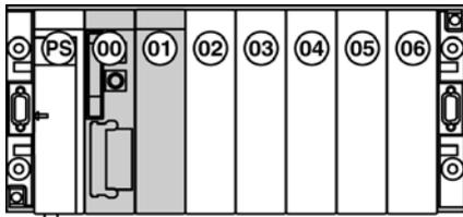
**配有双槽电源模块的机架：**
