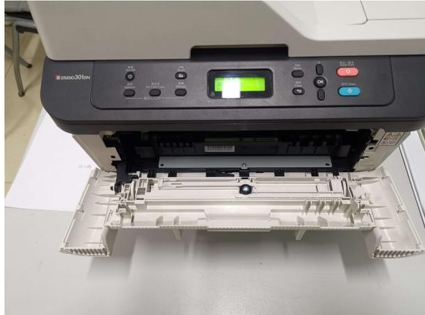
① . 打开打印机前盖，显示“盖子被打开，关闭前盖”。
