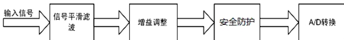
模拟量输入采样前端调理电路图
