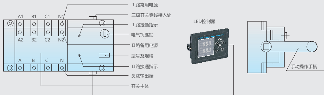
NH42B-16~630/SZ I、II、III型上两进下一出接线方式（三级开关的N及未安装接线端子与触头）
