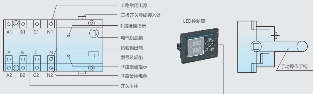
NH42-16~630/SZ I、II、III型上下进下一出接线方式(三极开关的N极未安装接线端子与触头)
