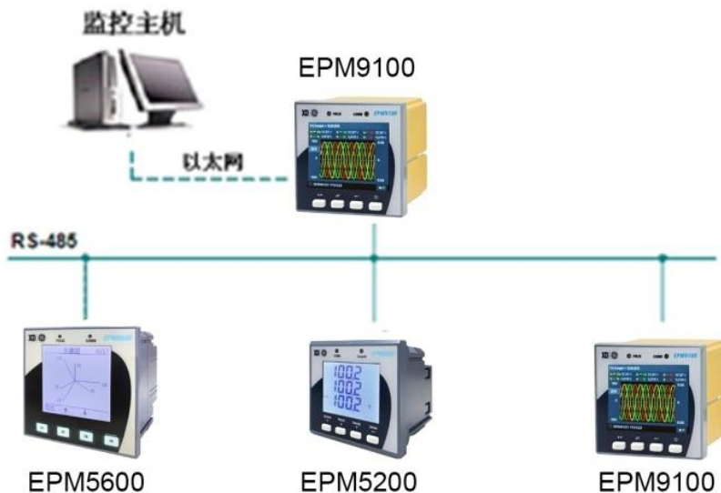
图 5-13 Ethernet Gateway 功能组网结构图 1
