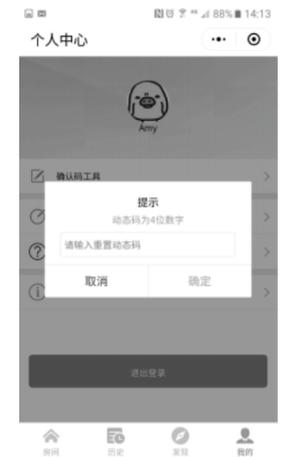
15、输入4位动态码(唤醒面板后输入\*#06#获取，10分钟有效)，生成门锁初始化确认码
